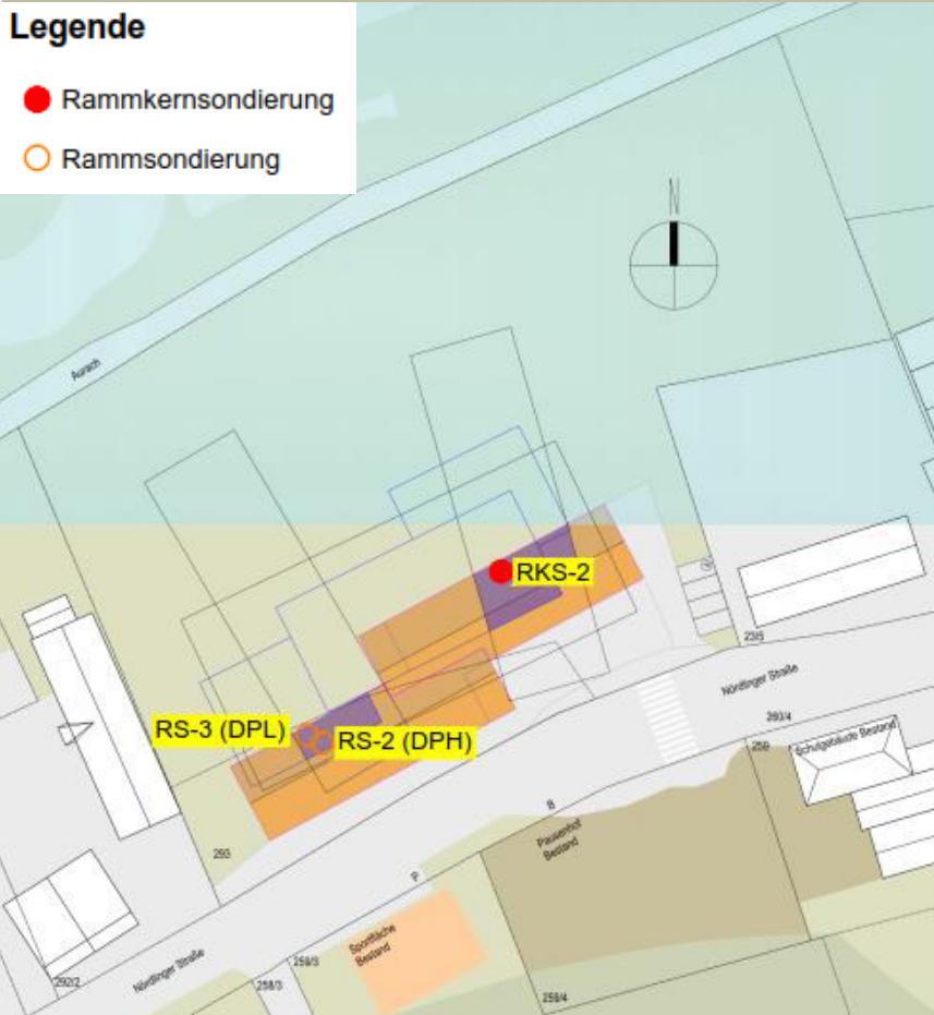
Ausschnitt aus Baugrundgutachten - Anlage 1 Blatt 3 Lageplan mit Aufschlusspunkten - Barthelmesaurach
